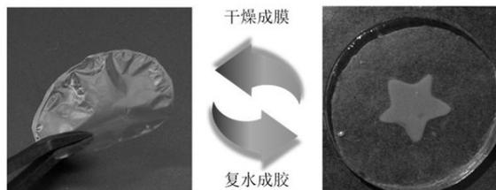
1. 一种用于防伪的温湿致变色复合膜的制备方法,其特征在于:将温致变色材料与水凝胶基质溶液混合得到混合溶液,浇筑并冷却制得温致变色凝胶;将未掺杂温致变色材料的水凝胶基质溶液浇筑在温致变色凝胶上,冷却构成温致变色复合凝胶;将温致变色复合凝胶进行热压干燥,即得到所述的温湿致变色复合膜;该温湿致变色复合膜包含未掺杂温致变色材料的非变色区与温湿致变色区,通过浸泡在水中溶胀形成凝胶,在加热条件下实现加密信息的获取,用于构建防伪系统。
